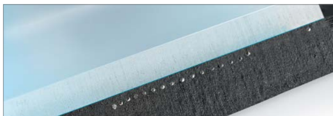
Rys. 11-2 Wtopiony drut elektrooporowy
