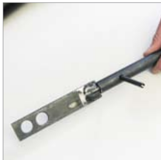
Rys. 01: Przyrząd wprowadzający wsunąć na trzpień i wbić kołek rozprężny młotkiem.
