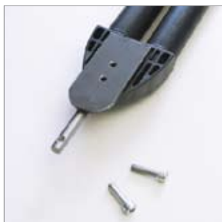
Rys. 01: Płaskownik umieścić w wyżłobieniu.
