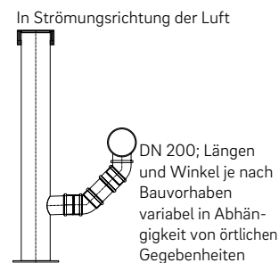
Abb. 05-20 Einfachabzweig, Darstellung in Strömungsrichtung der Luft
