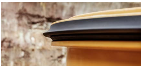
Abb. 05-28 Korrekten Sitz der Dichtung sicherstellen
