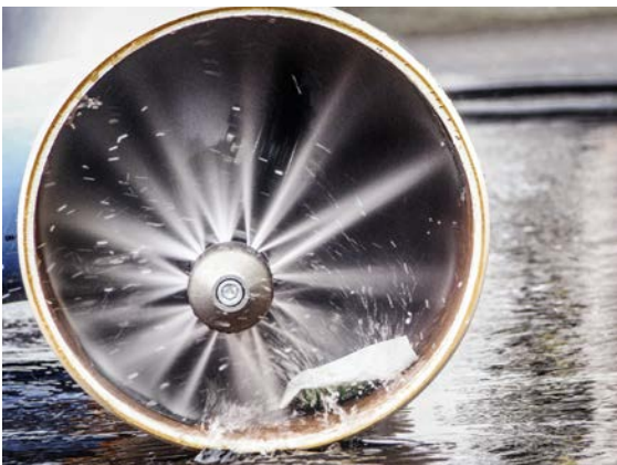
Abb. 06-2 Reinigung mit Wasserhochdruck
