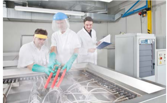
Fig. 06-20 Dans l'essai de longue durée, la résistance des tuyaux aux températures et à la pression est contrôlée
