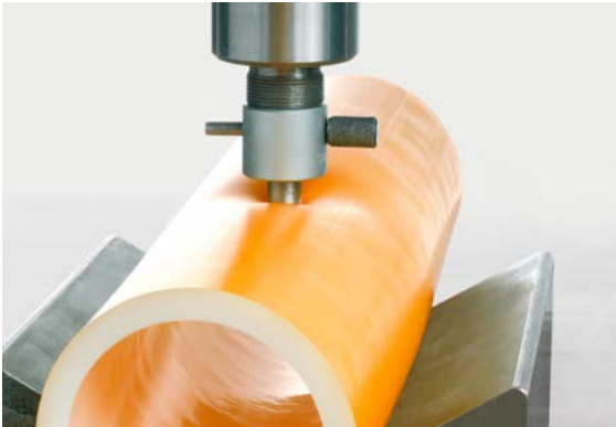
Fig. 03-6 Test sous charge ponctuelle
