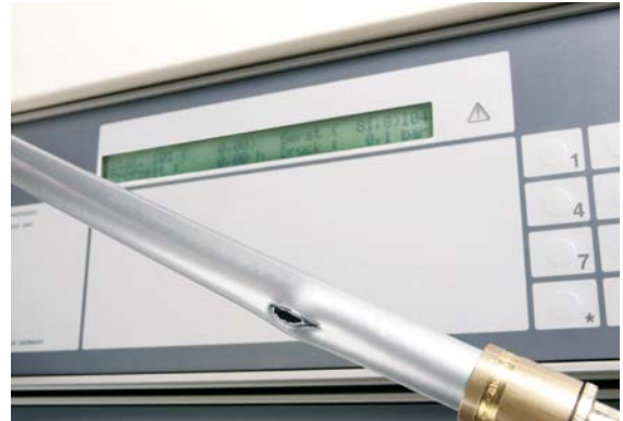
Fig. 03-8 Essai de pression d'éclatement
