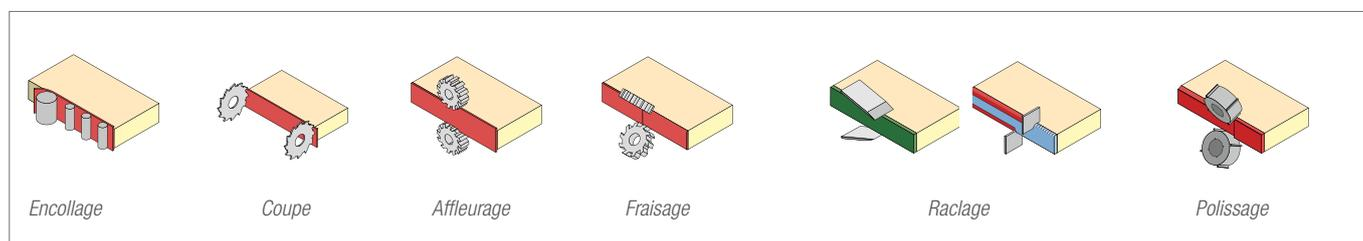
Pour une dépose de bande de chant de qualité et de longue durée de vie il est conseillé de respecter plusieurs paramètres importants comme les composants utilisés (bandes de chant, colle et panneaux) mais aussi paramétrage de la plaqueuse et température ambiante. Pour définir les paramètres optimaux il est recommandé de réaliser des essais préalables et de respecter les préconisations de chaque fabricant
