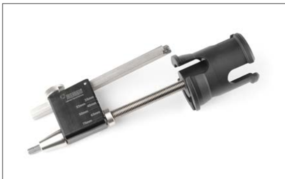
Abb. 03-3a Zum Schälen der Rohrenden muss ein Rotationsschäler verwendet werden. Das Bild zeigt den „SMARTFUSE DUO 25-75“. Antrieb über Handkurbel oder Akkuschauber möglich.
