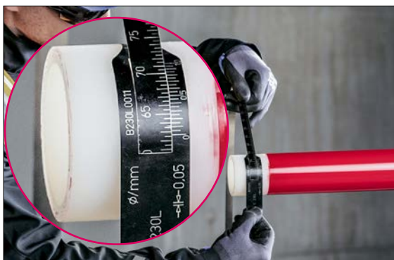
Abb. 03-6 Der minimal zulässige Außendurchmesser muss eingehalten werden (gemäß Tab. 03-3). Vor einer evtl. notwendigen Nachbearbeitung ist zu prüfen, ob der vorhandene Außendurchmesser einen weiteren Schälvorgang zulässt (Spandicke 0,1 – 0,3 mm, abhängig vom Rotationsschäler). Notfalls Farbrückstände mit Handschaber entfernen.
