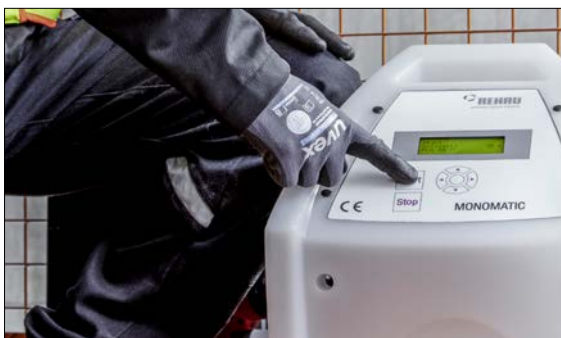
Abb. 03-15 Schweißparameter im Display überprüfen und durch Drücken des Startknopfes bestätigen. Nochmaliges bestätigen der Anzeige startet den Schweißvorgang.
