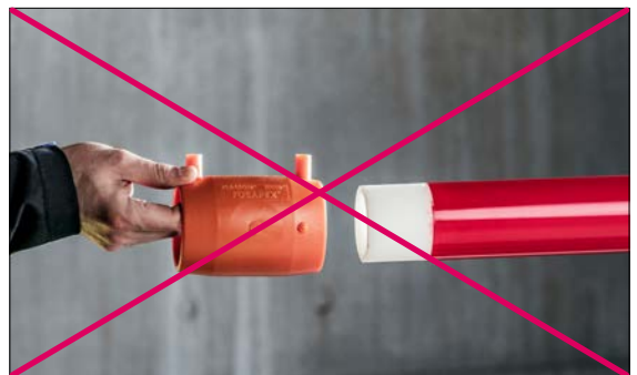
Abb. 03-27 Schweißzonen in der Elektroschweißmuffe nicht berühren. Notfalls verunreinigte Schweißzonen mit Tangit Reiniger vor dem Verschweißen reinigen.
