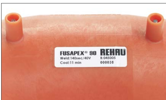
Abb. 03-17 Während der am Fitting angegebenen Abkühlzeit darf die Verbindung nicht belastet werden. Bei Rohren unter Spannung (z.B. Ringbandverlegung) ist die erweiterte Abkühlzeit nach Tab. 03-4 einzuhalten. Erst danach darf die Rohrhalterklemme entfernt werden.
