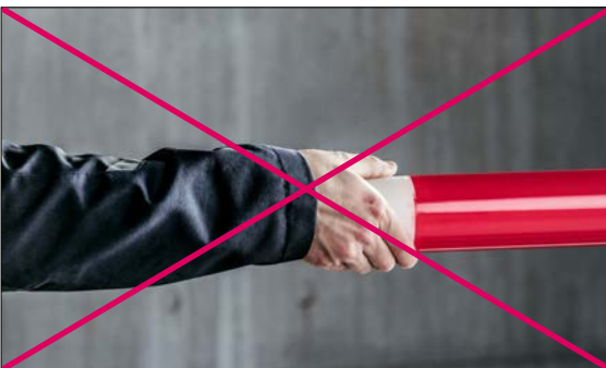
Abb. 03-26 Schweißzonen am Rohrende nicht berühren. Notfalls verunreinigte Schweißzonen mit Tangit Reiniger nochmals reinigen.
