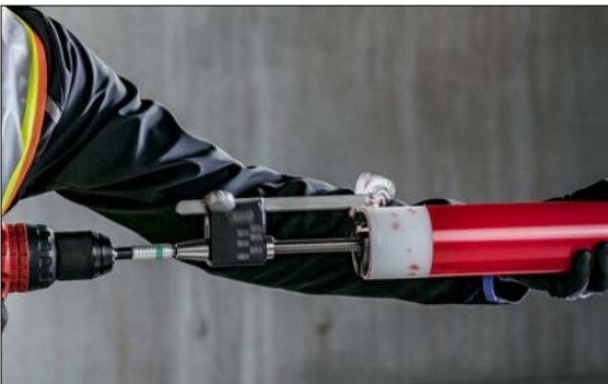
Abb. 03-37 Soweit ein 2ter Schälvorgang zulässig ist, erfolgt dieser in der gleichen Ausführung wie der 1te Schälvorgang.
