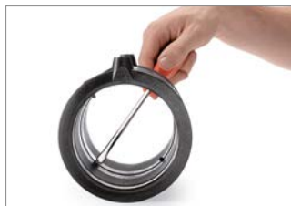
Abb. 40: Falls Muffe als Überschiebmuffe eingesetzt werden soll, sind die Anschlag-nippel zu entfernen.
