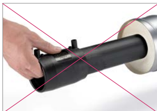
Abb. 39: Elektroschweißmuffe nicht innen berühren.
