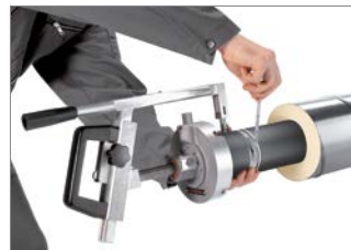
Abb. 45: Wenn ESM schwergängig aufzuschieben, Außendurchmesser mit Umfangsbandmaß gemäß Tab. 8 überprüfen und gegebenenfalls mit Rotationsschäler wiederholt schälen.
