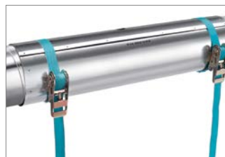
Abb. 80: 6. Zweiten Spanngurt neben der gegenüberliegenden Bohrung fixieren und beide fest spannen. Das axiale Dichtungsband muss mindestens vollständig überlappt sein.
