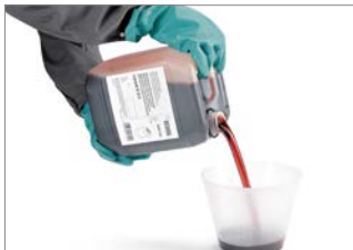
Abb. 67: 3. Komponente B (gelb) nach Tab. 9 dazu gießen. Die Reaktionszeit (Startzeit) beträgt jetzt ca. 50 Sekunden. (Abbildung ähnlich)
