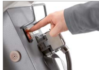
Abb. 43: Hauptschalter des Schweißgerätes befindet sich auf der Rückseite.
