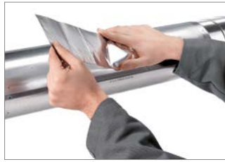
Abb. 62: 2. Offene Einfüllöffnung und alle 6 Entlüftungslöcher mit Aluminiumklebeband entsprechender Länge verschließen. Einfüllöffnung auch von innen verschließen.
