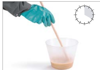
Abb. 68: 4. Reaktionsgemisch gut verrühren, Homogenität bringt die Qualität.
