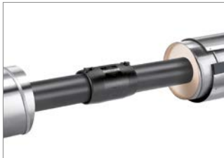
Abb. 49: 4. Verbindungsstelle säubern (sie darf keine Feuchtigkeit aufweisen).
