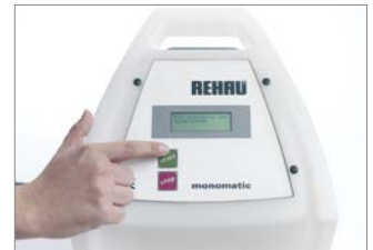
Abb. 31: 11. Auf dem Display angezeigte Schweißzeit mit der Angabe auf dem Fitting vergleichen. Startknopf des Schweißgeräts drücken und Anweisungen wie folgt überprüfen.
