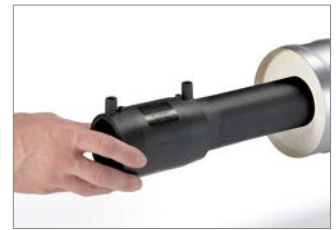
Abb. 27: 7. Elektroschweißmuffe auf das erste Rohrende schieben, Markierung Einstecktiefe gerade noch sichtbar.
