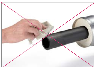
Abb. 41: Keine gebrauchten Lappen zum Reinigen einsetzen. Nur wasserfeste, unbenutzte Zellstofftücher verwenden.
