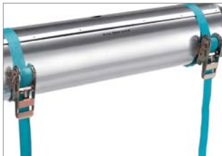
Abb. 51: 6. Zweiten Spanngurt neben der gegenüberliegenden Bohrung fixieren und beide fest spannen. Das axiale Dichtungsband muss mindestens vollständig überlappt sein.
