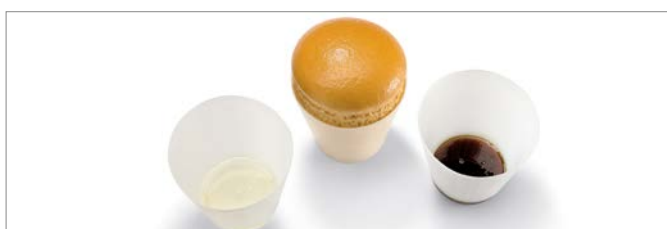
Abb. 13: Reaktionsgemisch frei verschäumt.
