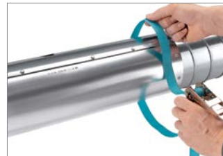
Abb. 85: 11. Beide Spanngurte lösen und abnehmen.
