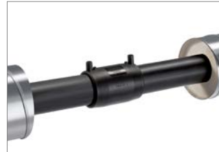
Abb. 28: 8. Zweites Rohrende in die Muffe schieben, beide Markierungen für Einstecktiefe gerade noch sichtbar.
