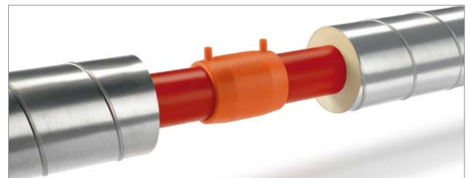
Abb. 4: RAUFRIGO-Rohr mit Basisrohr aus PE-Xa und Sauerstoffsperrschicht, verbunden mit Elektroschweißmuffe FUSAPEX
