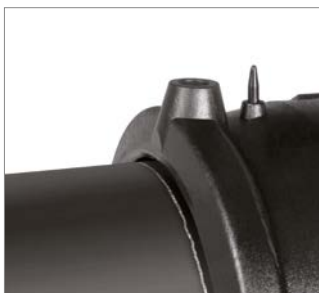
Abb. 9: herausgetretener Stift, optische Kontrolle wenn verschweißt
