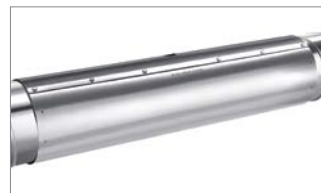
Abb. 59: 5. Die Isoliermuffe entlang der axialen Überlappung mit beiliegenden Bohrschrauben verschrauben und Spanngurte entfernen (siehe Abb. 52 und 53).
