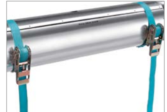
Abb. 55: 1. Isoliermuffe mittels Spannbändern befestigen (siehe Abb. 50 und 51).
