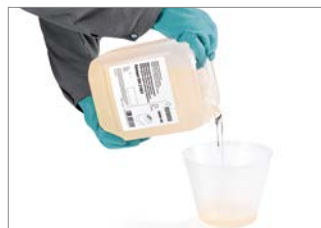
Abb. 66: 2. Nach Tab. 9 Komponente A (braun) in den Becher gießen. (Abbildung ähnlich)
