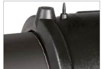
Abb. 44: Bei verschweißter Elektroschweißmuffe sind je Rohrende die Anzeigenippel hervorgehoben.
