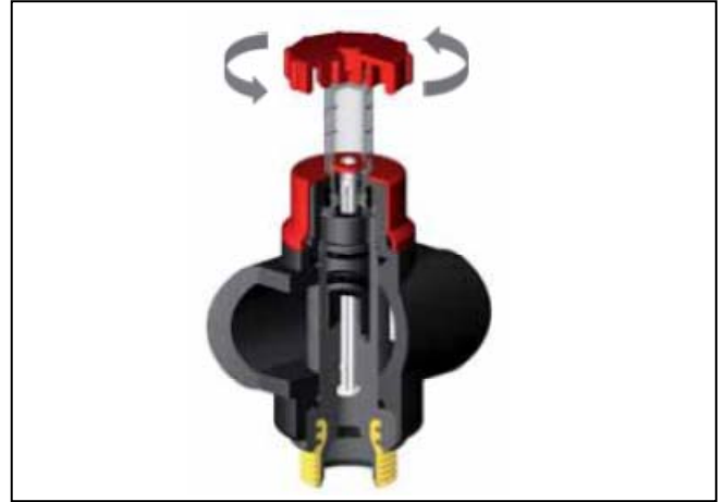
Fig. 1-4 Colector de impulsión abierto
