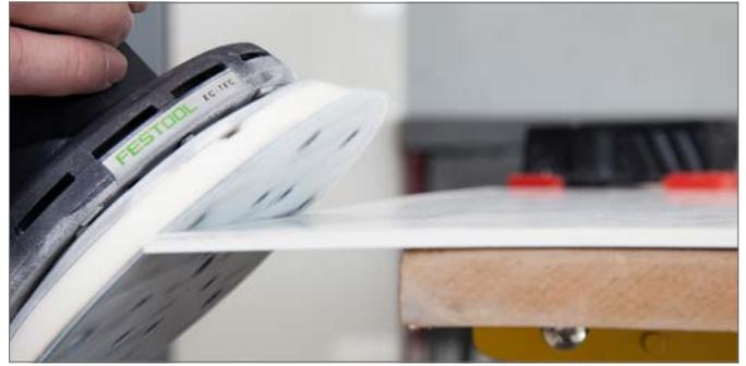
Los cantos de RAUVISIO crystal se pueden acabar con una lijadora orbital aleatoria y papel de lija de grano fino.
