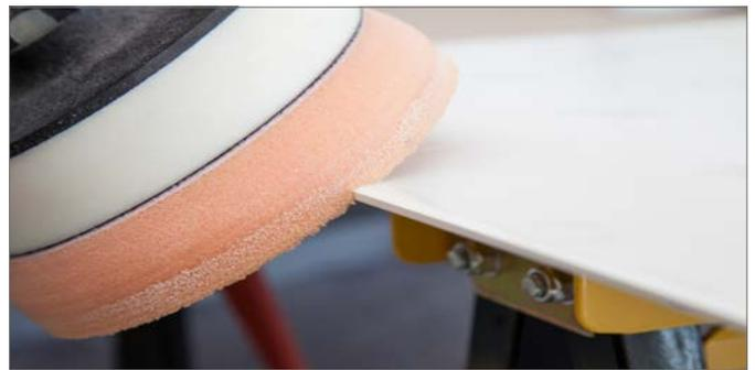
Con una pulidora rotativa y un pulimento de 1 paso puede obtener un resultado de brillo intenso. Como alternativa a la pulidora se puede realizar la operación a mano con un fieltro pulidor.
