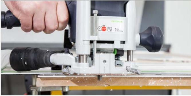
RAUVISIO crystal slim se puede cortar a la medida deseada con una fresadora superior y un raíl guía.
