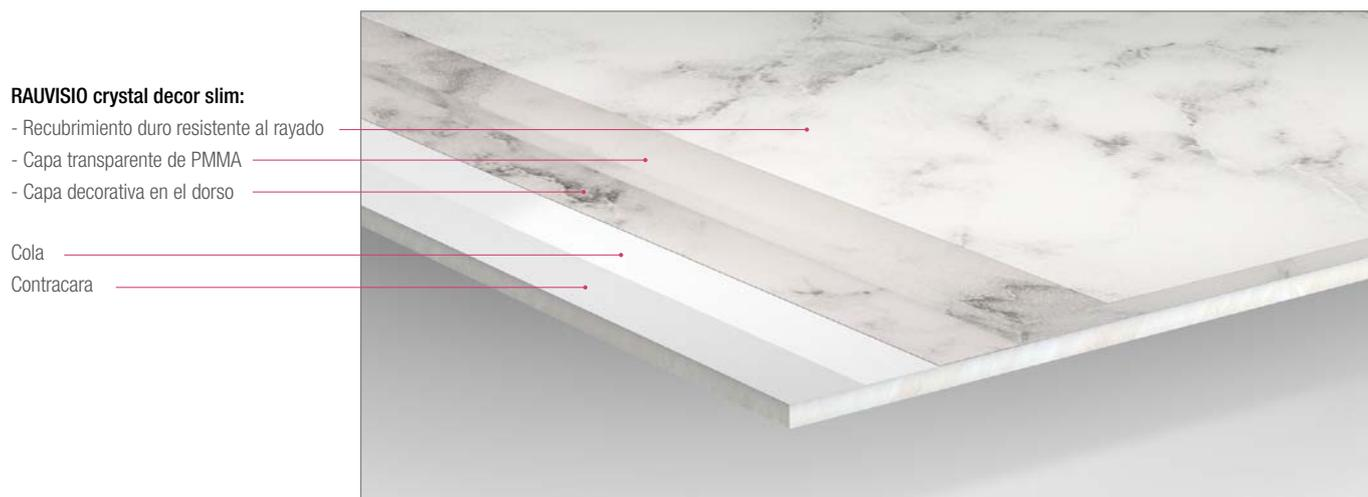
Fig. 7-2 Sistema compuesto RAUVISIO crystal decor slim
