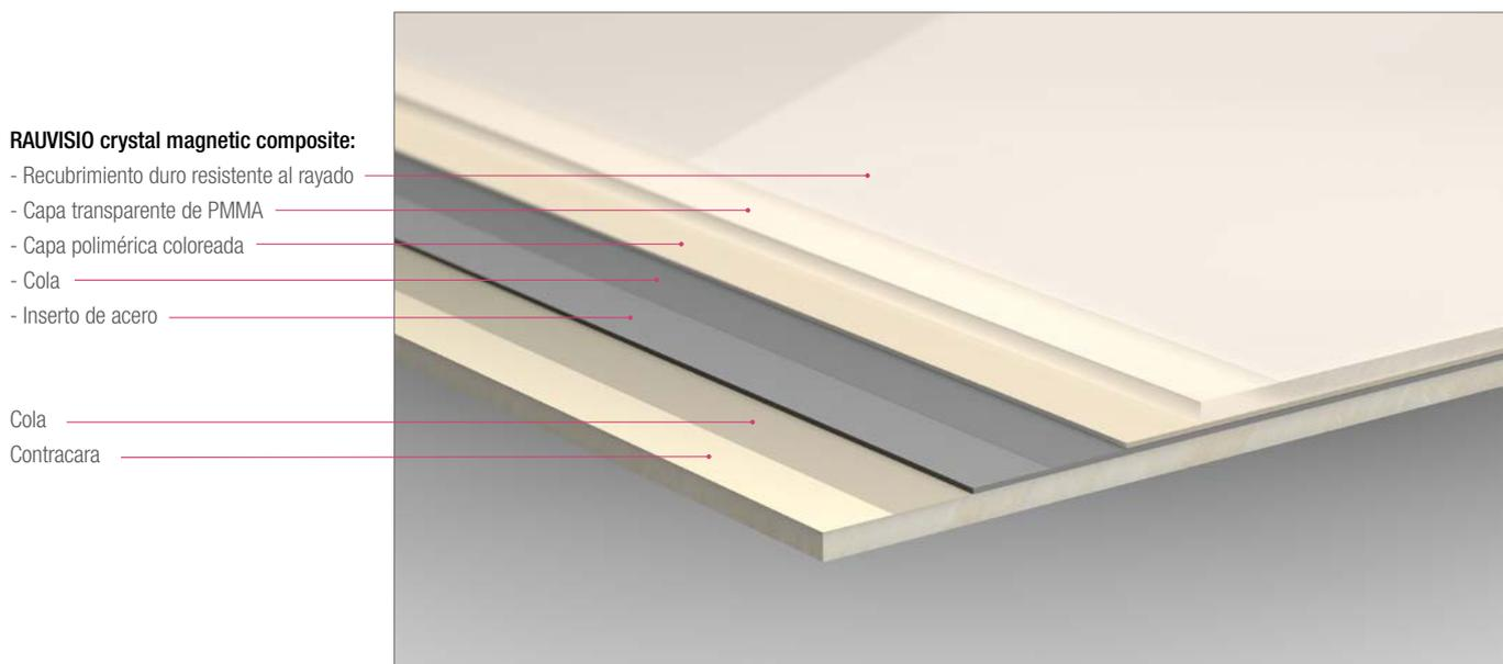
Fig. 4-2 Sistema compuesto RAUVISIO crystal magnetic slim
