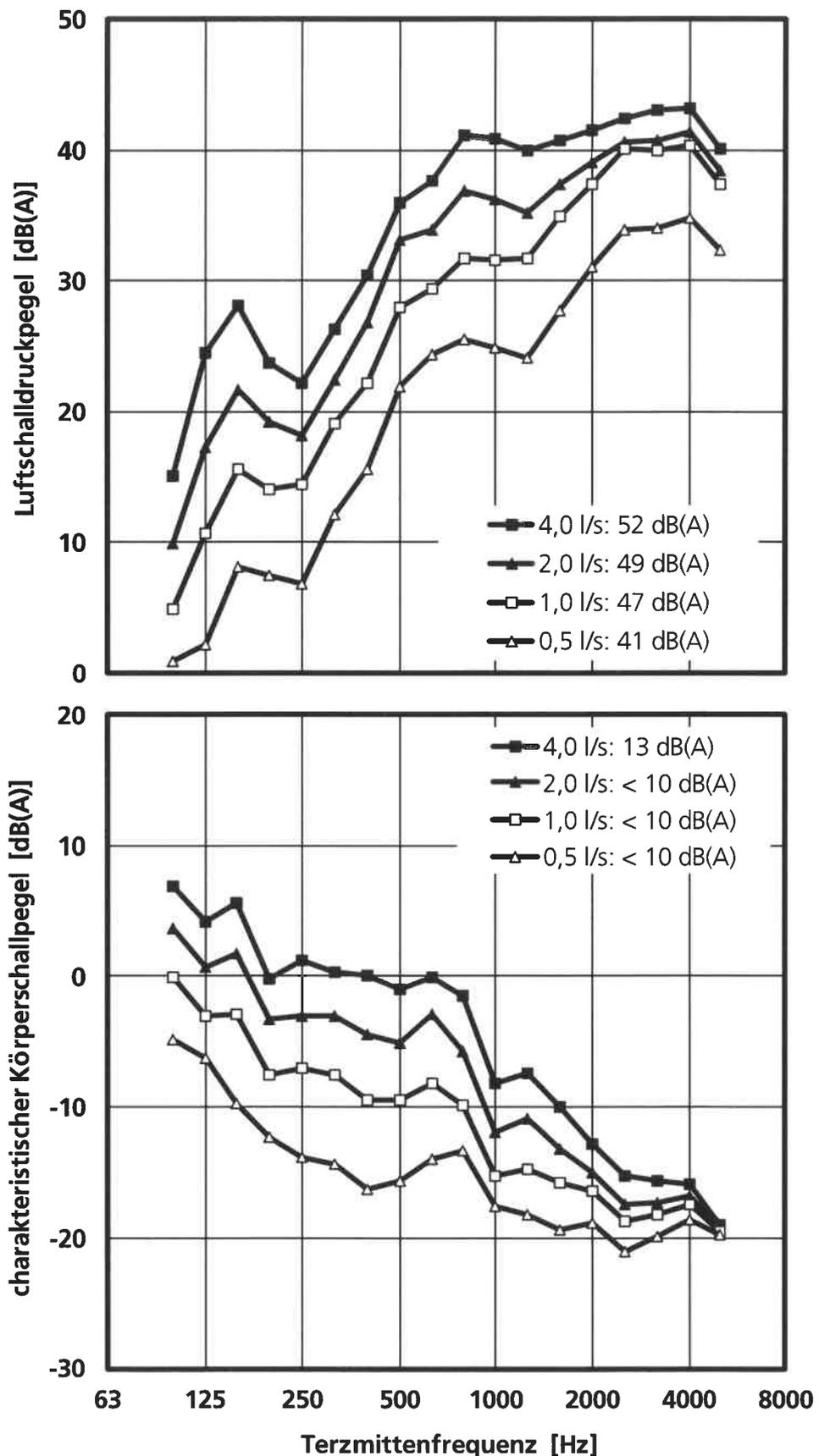
Frequenzspektrum des Luftschalldruckpegels  $L_{a,A}$  (oben) und des charakteristischen Körperschallpegels  $L_{sc,A}$  (unten) nach DIN EN 14366 bei verschiedenen Volumenströmen.
