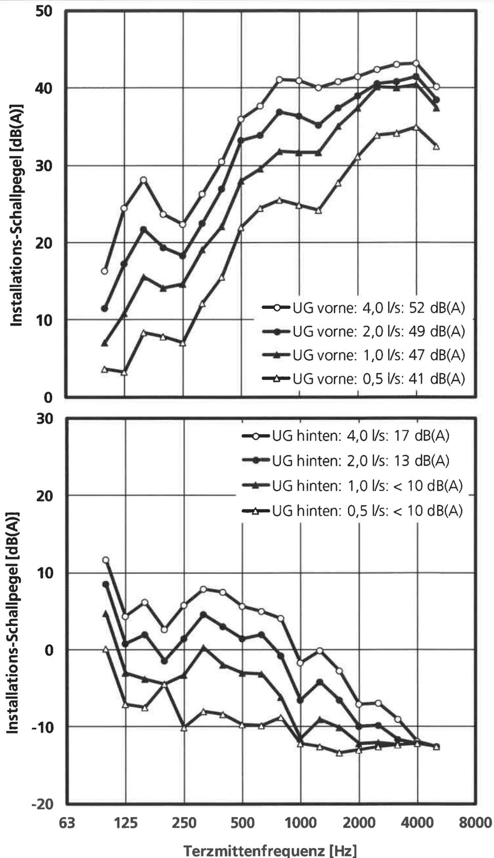
Frequenzspektrum des Installations-Schallpegels  $L_{A, \text{Freq}, n}$  in Anlehnung an DIN 4109 bei verschiedenen Volumenströmen, gemessen im Raum UG vorne (oben) bzw. UG hinten (unten).
