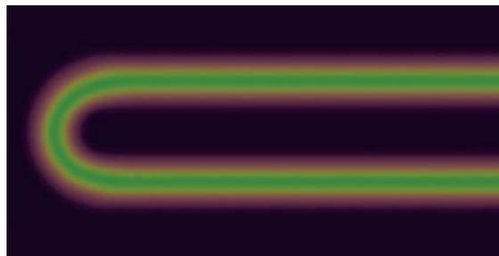
Abb. 06-33 Auffinden der mediumführenden Rohre durch Thermofolie
