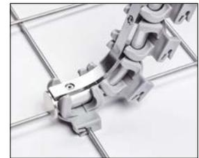
Abb. 04-114 und Abb. 04-115 Setzgerät mit magazinieren Drehclips positionieren
