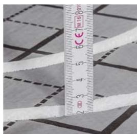
Abb. 04-147 Nuttiefe 20 mm zwischen Oberkante Dämmung und Nutscheitel
