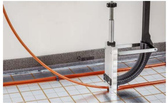
Abb. 04-101 Setzgerät für Rohrhaltenadeln
