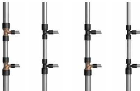
Fig. 05-6 Varianti di collegamento della tubazione ad anello
