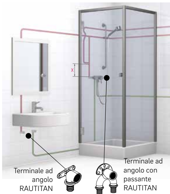
Fig. 05-4 Collegamento di valvole di miscelazione a flusso costante attraverso tubi dell'acqua calda - esempio di collegamento dall'alto
