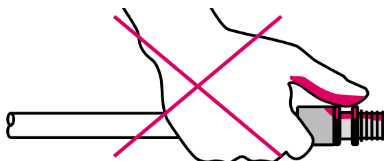
Fig. 26-24 RAUTITAN PX: evitare il contatto involontario con sostanze aggressive
