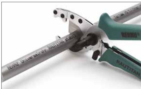
Fig. 27-1 Taglio di un tubo universale RAUTITAN stabil con la cesoia per tubi 16/20 RAUTITAN
