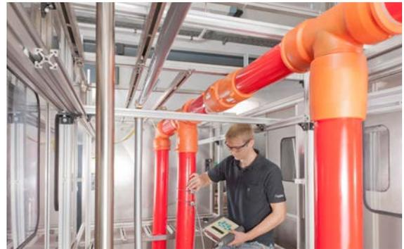
Fig. 06-21 Les tuyaux et la technique de raccordement sont testés comme un système
