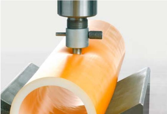
Fig. 03-6 Test sous charge ponctuelle
