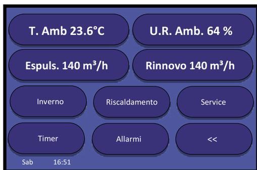
In alto ci sono due pulsanti che indicano la temperatura e l'umidità ambiente misurati. Se si preme su di essi si entra nell'impostazione del set rispettivamente della temperatura e dell'umidità.
