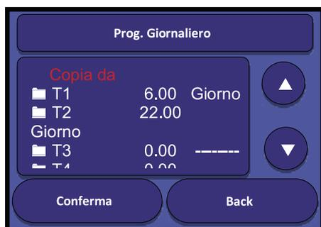
Entrando in ogni singola fascia si entra in un menù in cui è possibile impostare l'ora di inizio della fascia (in maniera esattamente uguale alla regolazione dell'orologio della macchina) e la modalità di lavoro.
