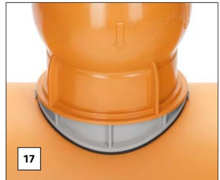
15. Dabei soll zwischen Anschlag und Rohr ein geringfügiger Spalt in etwa der Dicke eines 5 Cent-Stückes verbleiben. Der Anschlag darf auf keinen Fall auf dem Rohr aufsitzen.
