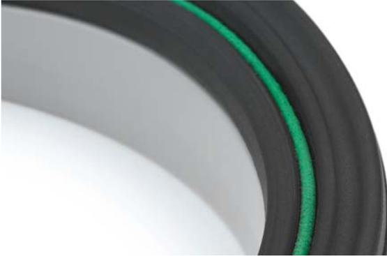
AWADOCK Polymer und AWADOCK kombinieren geniale Funktionalität mit einer einzigartigen Sicherheitstechnik. Die bewährte AWADOCK Anschlussdichtung sorgt für zuverlässige Dichtheit. Die grüne Sekundärdichtung aus Q-TE-C bietet zusätzliche Sicherheit. Entsteht eine Leckage zwischen Bohrloch und Dichtung, absorbiert sie das Wasser, vergrößert ihr Volumen und kann die Leckage schließen. Die dauerhafte Dichtheit ist somit wieder hergestellt.
