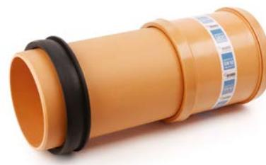
Mit dem Kombi-Set können Kunststoffrohre DN 250, DN 315 und DN 400 an Beton- oder Stahlbetonrohre angeschlossen werden. Dabei soll der Hauptrohrdurchmesser mindestens dem 2-fachen Bohrlochdurchmesser entsprechen.
