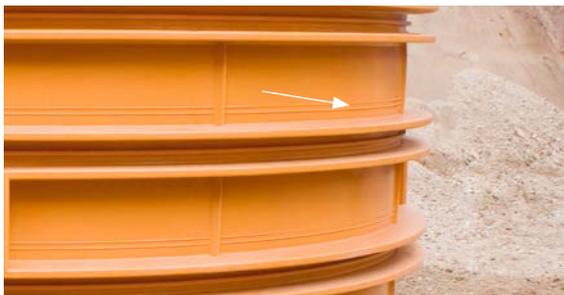
11 Die Schachtringe werden ungekürzt auf die Baustelle geliefert. Abhängig von der Einbautiefe des Schachtes muss der Schachtring ggf. um 125 mm gekürzt werden. Das Kürzen erfolgt zwischen den beiden Markierungslinien oberhalb der Dichtkammer. Siehe auch Punkt 15.
