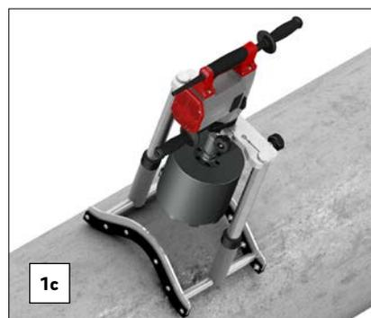
1. Das Bohrgerät mit geeigneten Mitteln zwischen 270° und 90° fixieren (z. B. mit Bohrstativ, Erdnägeln, Saugglocke, Spanngurten).
