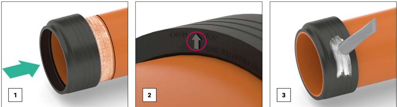
1. Der EAR wird auf das Kunststoffrohr bis zur Anschlaglippe am EAR aufgeschoben, ggf. unter der Verwendung von silikonfreiem Gleitmittel. Der Innendurchmesser des EAR ist auf Rohre aus PP gemäß DIN EN 1852-1 ausgelegt. Entsprechend können auch andere Rohre mit einem Außendurchmesser von 200 mm, 250 mm bzw. 315 mm (z. B. aus PVC oder aus PE) mit dem EAR versehen werden.
