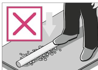
Fig. 3-10 Protéger les tuyaux contre les dégâts mécaniques.
