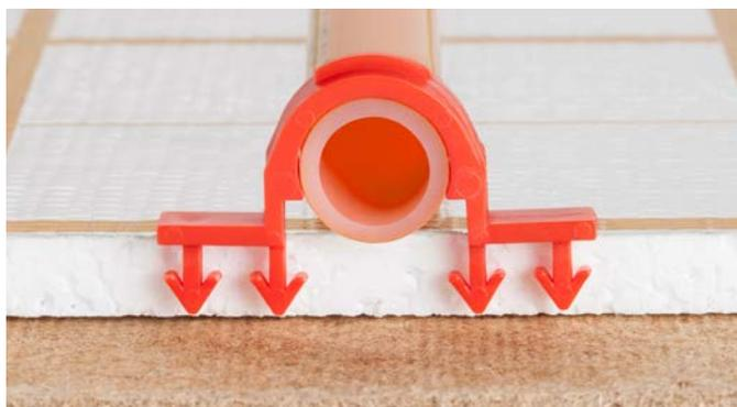
Fig. 4-102 Système de maintien de tuyaux RAUTAC 10 sur plaque isolante en fibre de bois WF Knauf<sup>1)</sup>
