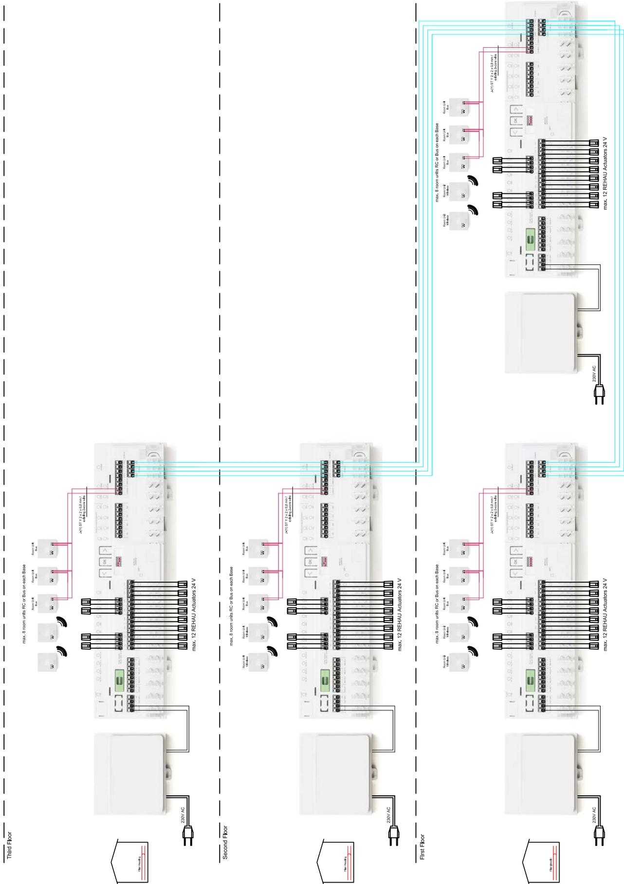
Img. 11-9 Instalación de grandes dimensiones con regulación de la temperatura ambiente – Calefacción por suelo radiante – Edificio sector terciario
