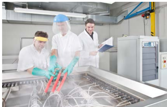
Afb. 06-20 Tijdens de duurtest worden de buizen op hun temperatuur- en drukbestendigheid beproefd
