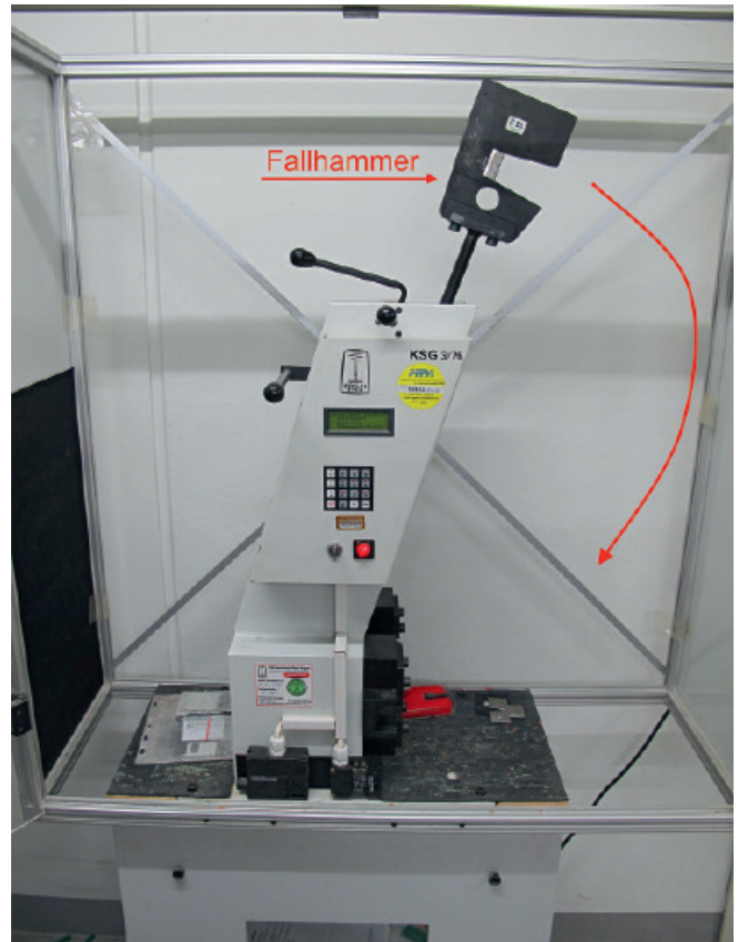
Abb. 6: Prüfeinrichtung für Charpy-Schlageigenschaften
