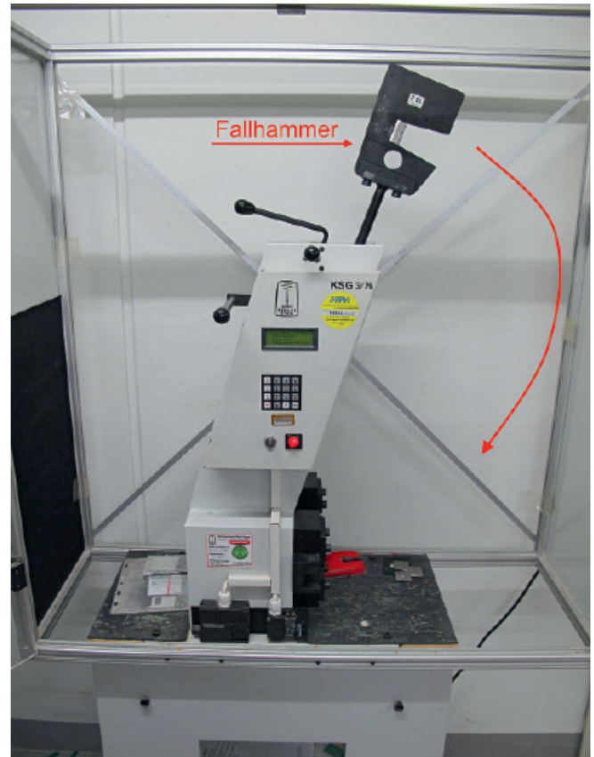
Abb. 6: Prüfeinrichtung für Charpy-Schlageigenschaften
