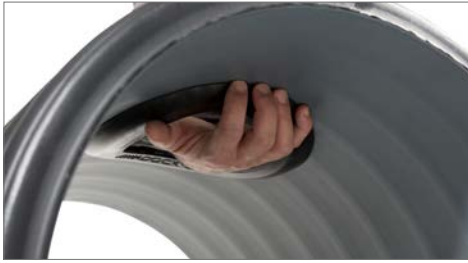
Bild 3: Bündiges Anliegen kontrollieren
