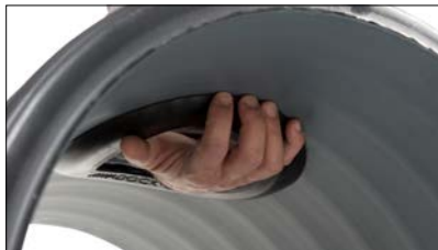
Abb. 3 Bündiges Anliegen kontrollieren
