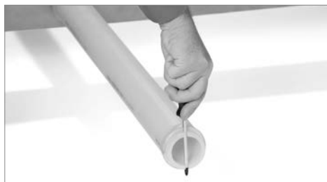
Rys. 3: Montaż przy użyciu klucza blokującego
