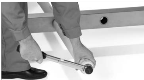
Obrázek 4: Montáž pomocí momentového klíče
