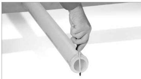
Obrázek 3: Montáž s přidržovacím nástrojem proti protočení
