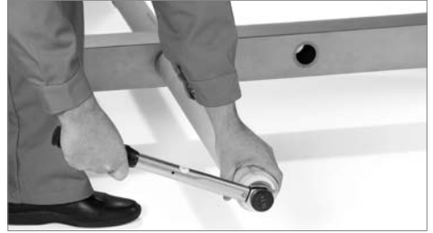
Bild 4: Montage mit Drehmomentschlüssel
