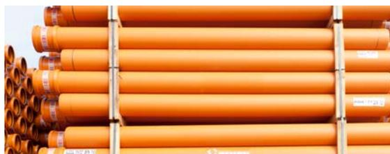
Nach dem Abladen sind Einzellängen auf ebener Fläche zu lagern und gegen Verzug zu sichern. Dabei ist darauf zu achten, dass sich keine scharfen, spitzen Gegenstände in die untere Rohrlage eindrücken.
