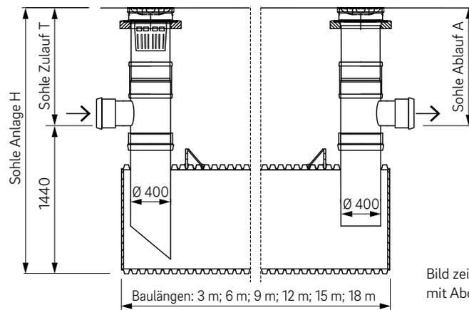
Bild zeigt beispielhaft eine M-Anlage mit Abdeckung Typ DN 400
