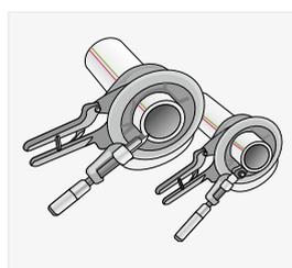
3. Per collegamenti con sistemi con manicotti a innesto, smussare le estremità dei tubi e rimuovere le bavature a circa  $15^{\circ}$  con l'aiuto di un utensile per smussatura o di una lima a taglio grosso.
