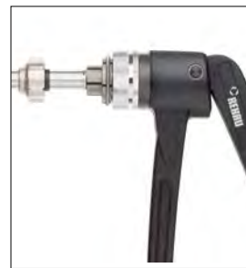
Rys. 12-5 Kielichowanie rury przyłączyowej
