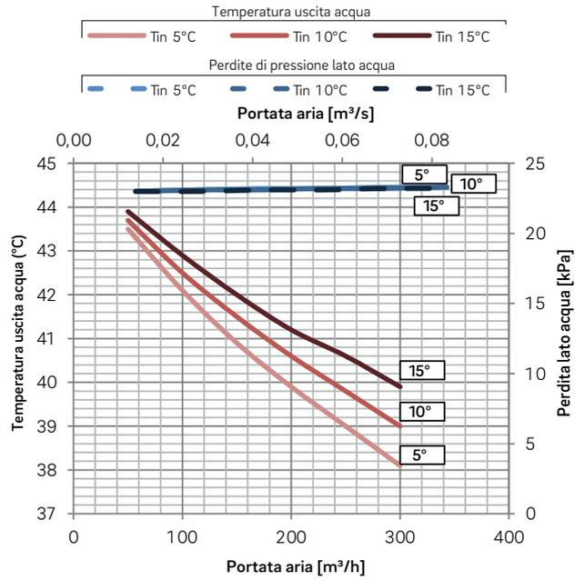
Batteria AIR DEH 1 IDRONICO (+7°C/+12°C)
