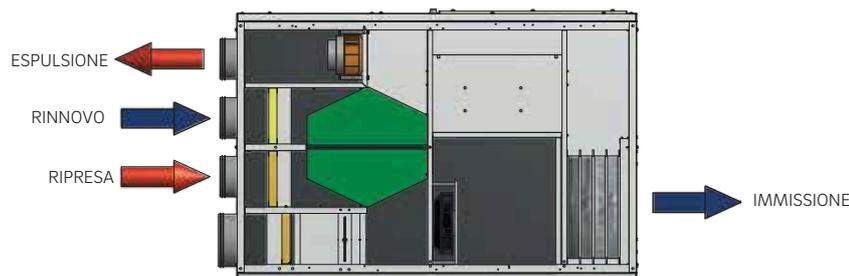
In caso non sia necessario attivare la deumidifica, l'unità funziona come una normale VMC ad alta efficienza; i costi di esercizio possono essere ottimizzati gestendo la macchina con fasce orarie, oppure in abbinamento a sonda di qualità aria CO<sub>2</sub> o CO /VOC (opzionale). Esempio (taglia 2): immissione, ripresa, rinnovo ed espulsione = 200 m<sup>3</sup>/h
