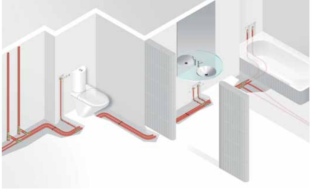
La pose en piquage pour les alimentations radiateurs et la distribution sanitaire avec les solutions REHAU a été conçue pour une mise en œuvre facile et rapide en neuf comme en rénovation. La technologie de sertissage REHAU rend les raccordements indémontables et permet une pose directement dans la chape. REHAU a développé un système unique de raccordement compatible avec RAUTHERM (PE-Xa) et RAUTHERM Multi (multicouche).
