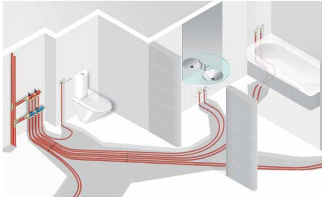
La pose en pieuvre pour l'alimentation radiateurs et la distribution sanitaire avec les solutions REHAU a été conçue pour une alimentation individuelle des appareils sanitaires et des radiateurs en neuf et en rénovation.
