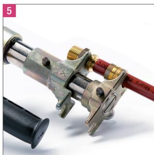
**5** Préparer l'outillage à sertir. Mettre en place les mors correspondant au diamètre du tube à sertir. Amener les mors contre la collerette du raccord et en butée de la bague.
