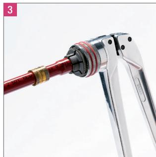
**3** Actionner le levier qui va élargir l'extrémité du tube. Rester quelques secondes dans cette position.
