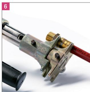
**6** Commencer le sertissage progressivement en amenant la bague en butée contre la collerette du raccord. Ne pas utiliser de lubrifiant ou d'eau.
