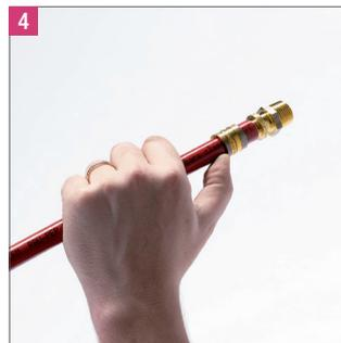
**4** Enfoncer le tube sur le raccord jusqu'à la butée de la collerette. Le tube se rétracte sur le manchon du raccord. Rapprocher la bague du raccord.
