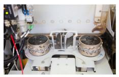
Ein weiterer Vorteil der synchronen Verstellung zeigt sich bei einem Konzept mit zwei Werkzeugen im Wechselfräsen: Der Fügefräser im Gegenlauf mit deutlich weniger Laufmetern und weniger Abnutzung muss weniger häufig nachgestellt werden. Bislang wurden in der Regel beide Fräser gleichzeitig gewechselt, obwohl ein Fräser schwächer abgenutzt wurde.
