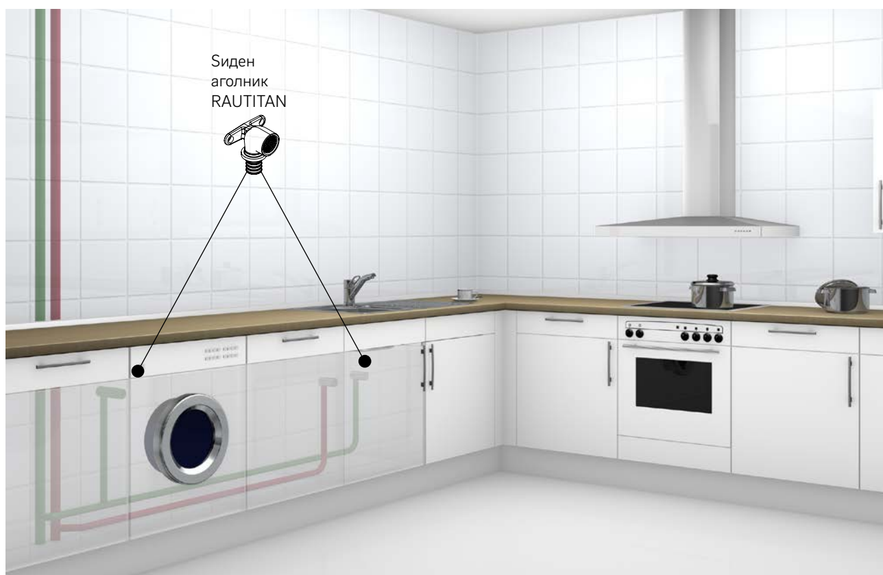
Сл. 05-2 Поставување Т-парче при катна/единична доводна линија со содржина на вода < 3 l - пример, кујна
