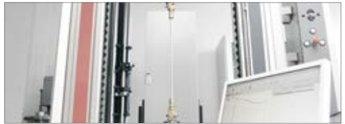
Afb. 3-3 Verloop van een trekproef
