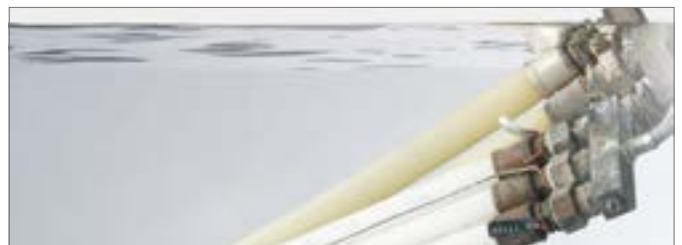
Afb. 3-4 Buizen in Duurtest (onder druk in waterbekken)
