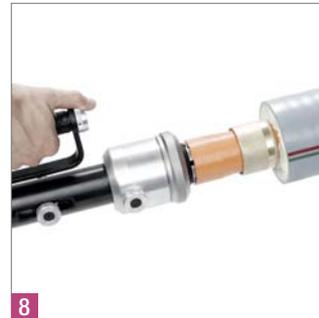
**8** Rohr zweimal um ca. 30° versetzt aufweiten.
