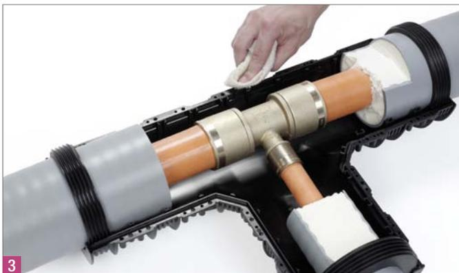
**3** Reinigen Sie die Klebeflächen, damit diese frei von Schmutz und Fett sind. Bestreichen Sie anschließend die Klebeflächen der Schale lückenlos mit dem mitgelieferten Schnellkleber.
