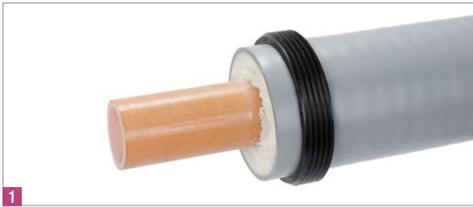
**1** Bringen Sie die Dichtringe auf und richten Sie die Lamellen vom Rohrende weg. Falls nötig reinigen Sie die Dichtringe und das Rohr. Verbinden Sie die Mediumrohre (siehe 5.3 Rohrverbindung, Punkt 7 ff.).
