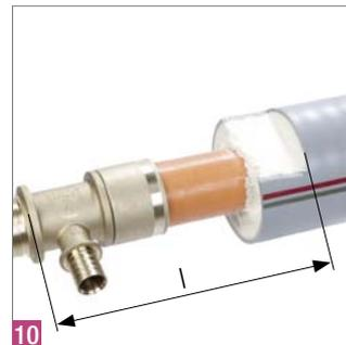
**10** Schneiden Sie, falls nötig, für die weitere Schiebehülseverbindung, einen Keil als Freiraum für das Verpresswerkzeug aus. Die Isolierung ist dann wie in der Tabelle angegeben zu entfernen.
