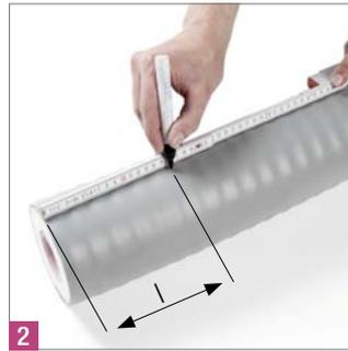
**2** Abisolierlängen nach Mediumrohr-Außendurchmesser:
