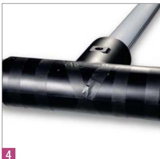
**4** Ziehen Sie die T-Muffe über die Durchgangsleitung zurück und fixieren Sie diese über Kreuz mit Gewebeband jeweils an den Enden und in der Mitte (5x).
