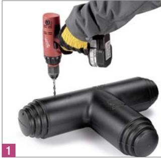
**1** Stellen Sie Entlüftungsöffnungen mit einem 3 mm Spiralbohrer an den Durchgangsseiten und eine Schaumfüllöffnung mit einem Forstnerbohrer 25 mm, entsprechend dem Durchmesser des abgehenden Rohres an der am Abzweig gekennzeichneten Stelle her.
