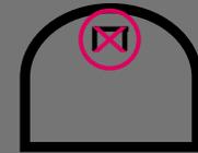
Bei Modellfenstern reduzierte Stabilität aufgrund der fehlenden Armierung im Bogen!
