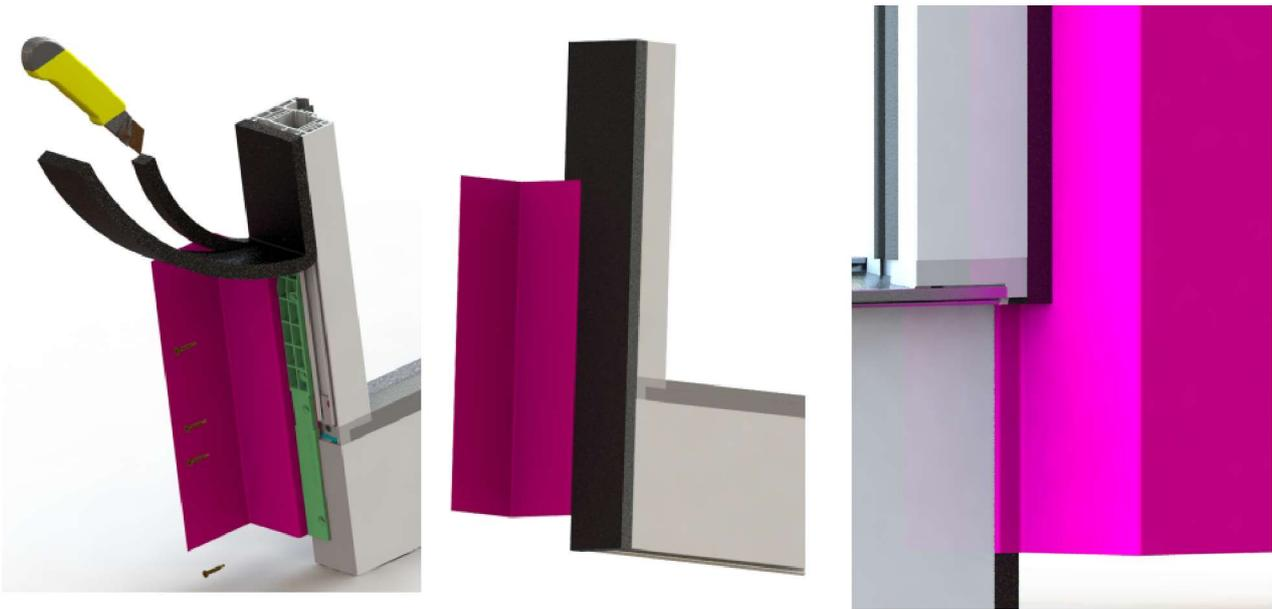
Der Anschlussflansch (re/li) wird mit den mitgelieferten Schrauben an den senkrechten Rahmenprofilen montiert. Die Montagesciene definiert die Höhenposition und soll mind. 150 mm über Fußbodenoberkante betragen. Bei flächenbündiger Ausführung liegt der Anschlag am 2. Rastfuss, bei der flächenversetzen am 3. Rastfuß des Blendrahmens. Austretender Dichtkleber ist bündig abzuziehen.
