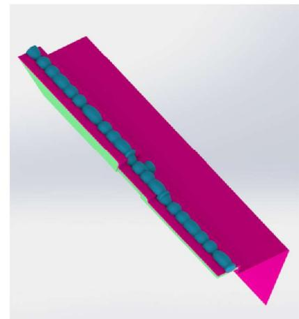
Der REHAU-Montagekleber FIX ALL SEASONS (1366797) muss durchgehend satt füllend in der Hohlkehle des Flansches aufgetragen werden. (Alternative Dichtstoffe sind nicht geprüft)
