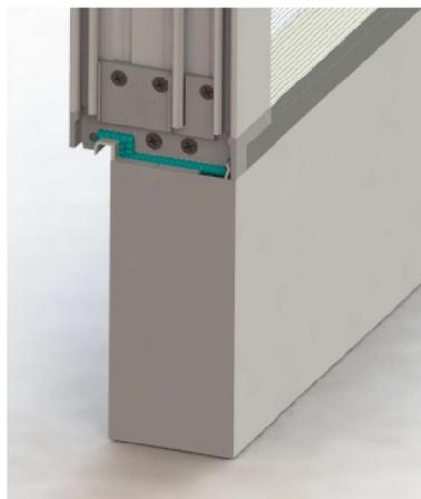
Verschließen der Kammern am Bodeneinstandsprofil mittels einer Klebefolie. Kontaktfuge zwischen Schwelle und Unterbauprofil abdichten.
