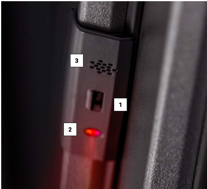
1 Detektor pokreta 2 LED lampica 3 Predajnik signala
