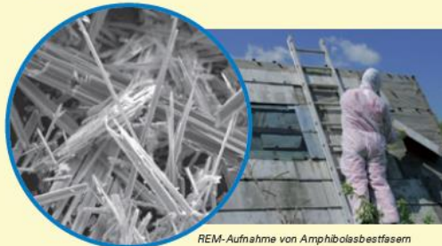
REM-Aufnahme von Amphibolbestfasern
