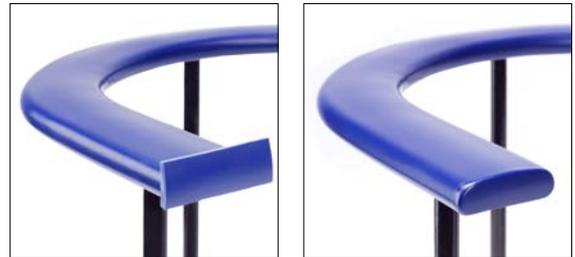
Für engere Radien übernimmt REHAU keine Gewährleistung. Nach dem Erkalten des aufgezogenen Handlaufs werden die Enden sauber abgeschnitten, wobei man aufgrund des möglichen Rückschrumpfens das Profil etwa 2 bis 5 cm (je nach Profillänge) überstehen lässt. Es ist vorteilhaft, wenn der Profilabschluss erst nach einigen Tagen bearbeitet wird.
