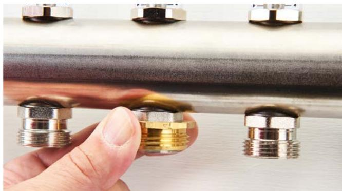
6. Insérez l'insert cannelé de 3/4 po après avoir installé le joint torique dans la douille. Poussez fermement jusqu'à ce qu'il soit complètement inséré.
