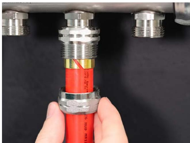
**AVIS :** si la bague fendue n'est pas positionnée fermement contre le collier de raccord cannelé, l'écrou de compression ne pourra pas être vissé sur la douille à l'étape 8.
