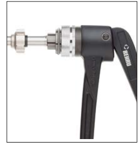
Abb. 14-5 Rohrende einmal aufweiten
