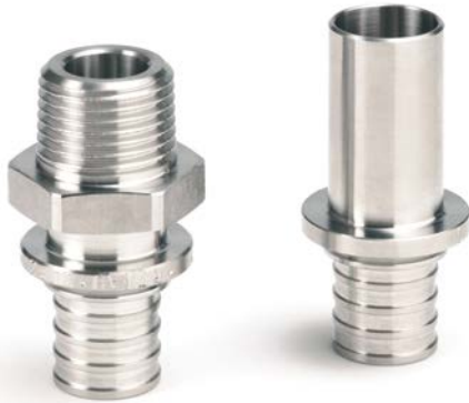
Abb. 27-14 Systemübergang mit Außengewinde RAUTITAN SX aus Edelstahl und System-Pressübergang RAUTITAN SX aus Edelstahl
