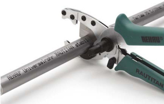
Abb. 28-1 Ablängen eines Universalrohrs RAUTITAN stabil mit der Rohrschere 16/20 RAUTITAN
