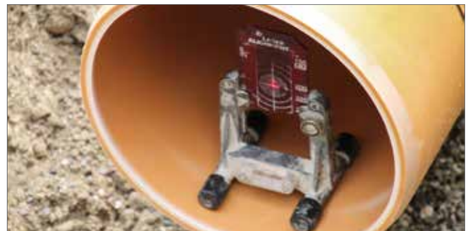
Afb. 5-12 Controle afschot (helling) met een laser
