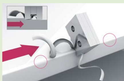
Schritt 2: Doppel-Ziehklinge für perfekte Geometrien
