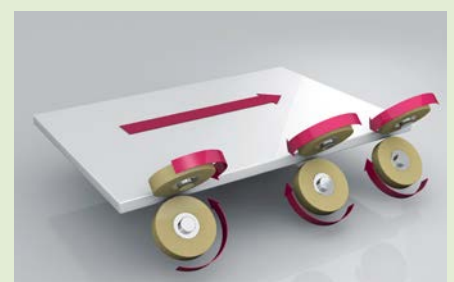
Schritt 3: Finishaggregat mit Poliereinheit
