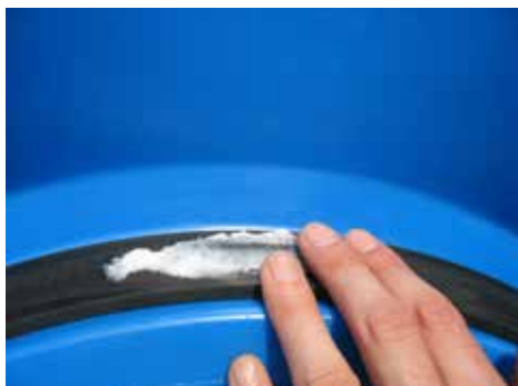
Insmeren van de afdichting met smeermiddel
