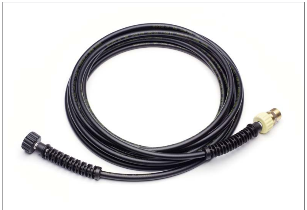
Verlängerungsleitung für Hochdruckreinigungsgeräte Pumpenanschluss 14 und 15 mm mit Gewinde M 22 x 1,5 mm.
