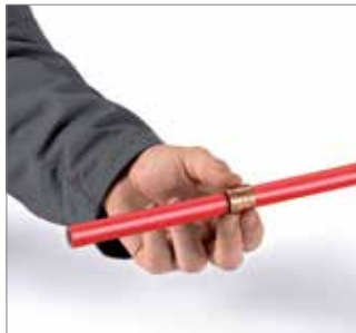
Rys. 12 2. Tuleję zaciskową nasunąć na rurę. Wewnętrzne skośne zatoczenie (frez) musi być skierowane w kierunku końcówki rury.
