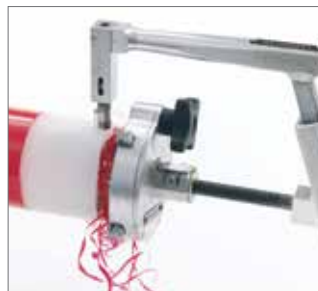
Rys. 93 Rurę oskrobać dwukrotnie.
