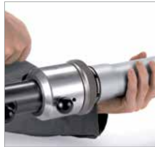
Rys. 19 3. Kielichować rurę dwukrotnie za pomocą narzędzia RAUTOOL G1, obracając je o 30°.
