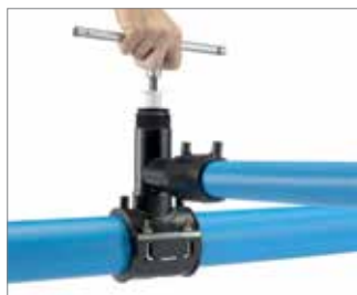
Rys. 62 9. Po wykonaniu próby ciśnieniowej wkręcić do rury głównej przebijak ręczny za pomocą klucza imbusowego.
