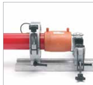
Rys. 98 Nałożyć na rurę uniwersalny uchwyt mocujący możliwie jak najbliżej mufy elektrooporowej FUSAPEX.
