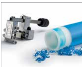
Rys. 70 W celu usunięcia wierzchniej warstwy za pomocą skrobaka automatycznego czynność wykonywać tylko raz, pozostałości warstwy wierzchniej nie wpływają na proces zgrzewania; najważniejsze jest usunięcie najbardziej zewnętrznej warstwy (warstwy tlenowej).
