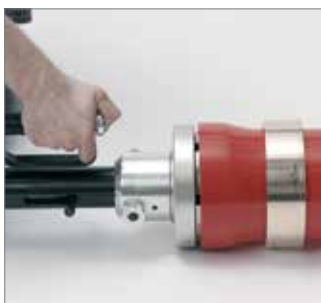
Rys. 29 4. Czas wsuwania złączki w rurę może być skrócony przez przytrzymanie przycisku kielichowania przy maksymalnie otwartej głowicy kielichującej (czyli w pozycji końcowej w procesie kielichowania).
