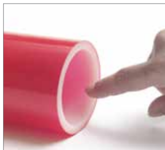
Rys. 109 W razie ewentualnej owalizacji rury, należy przywrócić jej kołowy kształt.
