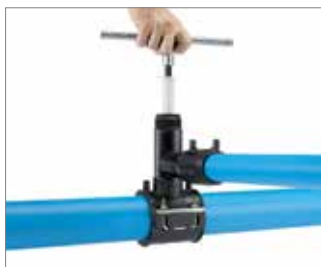
Rys. 63 10. Po zrobieniu otworu w rurze głównej wykręcić przebijak ręczny przeciwnie do ruchu wskazówek zegara.
