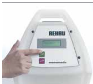
Rys. 103 Ponowne naciśnięcie przycisku START inicjuje proces zgrzewania.
