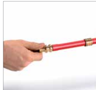
Rys. 14 4. Króciec złączki umieścić w kielichu rury. Po chwili złączka zaciśnięta jest na stałe w rurze.
