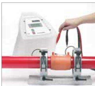
Rys. 104 Po zakończeniu zgrzewania włącza się sygnał dźwiękowy. Na wyświetlaczu widać komunikat „OK”. Można wówczas wyciągnąć wtyczki.
