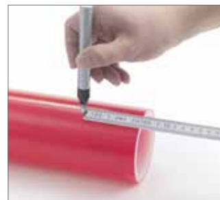
Rys. 91 Zaznaczyć na rurze obszar do zeszkrobania zgodnie z tab.16. Należy użyć pisaka w kolorze kontrastującym z rurą.
