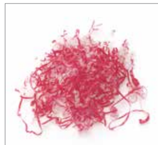
Rys. 112 Przy zeszkrobaniu zewnętrznej warstwy powinien powstać długi wiór o równomiernej grubości ( 0,1 - 0,2\text{ mm} ); w razie potrzeby wymienić skrobak i/lub ostrze.
