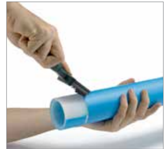
Rys. 42 3. Dokładnie usunąć wierzchnią warstwę za pomocą ręcznego skrobaka. Nie wychodzić poza zaznaczony obszar.
