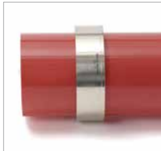
Rys. 27 2. Tuleję zaciskową nasunąć na rurę. Wewnętrzne skośne zatoczenie (frez) musi być skierowane w kierunku końca rury.
