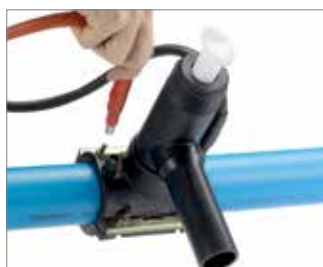
Rys. 58 5. Podłączyć zgrzewarkę; czerwony przewód włożyć do czerwonego gniazda. Parametry zgrzewania ustawiane są automatycznie.
