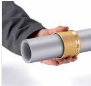
Rys. 18 2. Tuleję zaciskową nasunąć na rurę. Wewnętrzne skośne zatoczenie (frez) musi być skierowane w kierunku końca rury.
