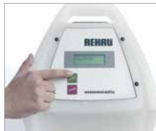
Rys. 49 10. Naciśnięcie przycisku „Start” zgrzewarki.
