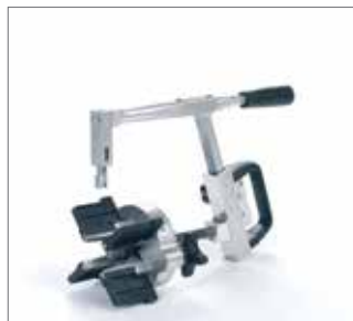
Rys. 92 W celu zeszkrobania warstwy zewnętrznej rury należy użyć skrobaka półautomatycznego.
