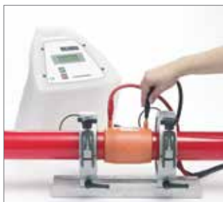
Rys. 100 Podłączyć zgrzewarkę, czerwony kabel do czerwonego styku. Parametry zgrzewania zostaną rozpoznane automatycznie.
