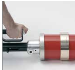
Rys. 28 3. Kielichować rurę dwukrotnie poprzez obrót głowicy kielichującej o 30°.
