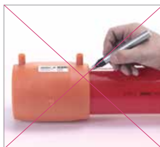
Rys. 118 Nie wykorzystywać mufy do zaznaczenia obszaru zgrzewania.
