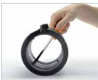
Rys. 78 Jeżeli mufa będzie użyta jako nasuwka, należy usunąć kolki oporowe.
