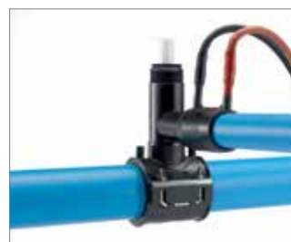
Rys. 61 8. Po 20 minutach chłodzenia wykonać podłączenie kolejnego przyłącza. Następnie przeprowadzić w instalacji próbę ciśnieniową podejścia.
