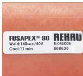
Rys. 105 Należy przestrzegać czasów stygnięcia zamieszczonych na kształtce elektrooporowej i w tym czasie nie należy obciążać rur mechanicznie.
