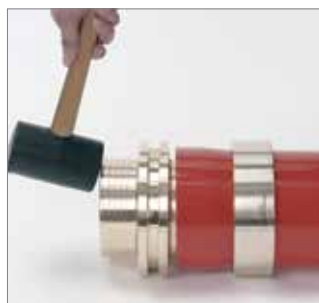
Rys. 31 6. Między pierścieniem oporowym złączki a końcem rury musi być stały odstęp. W razie konieczności pozycję złączki należy poprawić za pomocą gumowego młotka bezpośrednio po wsunięciu w rurę.
