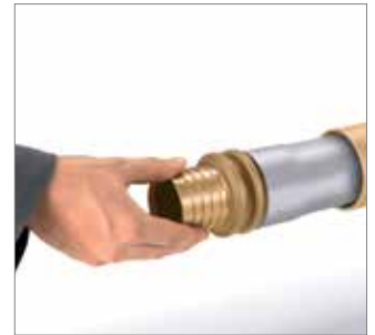
Rys. 20 4. Nasunąć kielich na króciec kształtki aż do pierścienia oporowego. Po chwili złączka zaciśnięta jest na stałe w rurze.
