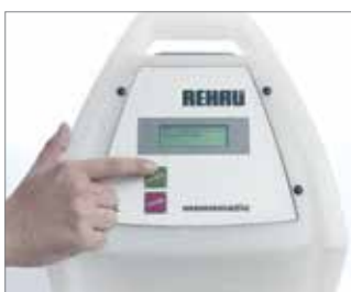
Rys. 51 12. Ponowne naciśnięcie przycisku „Start” rozpoczyna proces zgrzewania.
