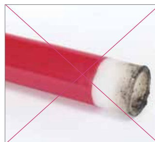
Rys. 120 Strefy zgrzewania nie mogą być mokre ani zabrudzone.
