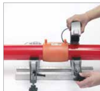
Rys. 106 Po upływie czasu stygnięcia zamieszczonego na kształtce można zdemonstrować uniwersalne uchwyty mocujące.
