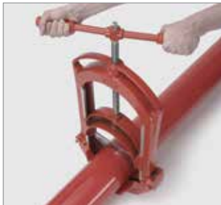
Rys. 25 1. Przyciąć rurę na żądaną długość za pomocą gilotyny...
