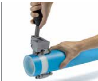
Rys. 43 4. W przypadku stosowania skrobaka automatycznego nie trzeba zaznaczać powierzchni do usunięcia. Powierzchnię rury skrobać tylko raz!
