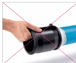
Rys. 73 Nie dotykać wnętrza mufy elektrooporowej.
