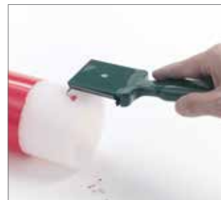
Rys. 94 Pozostałości warstwy zewnętrznej muszą zostać usunięte za pomocą skrobaka ręcznego.
