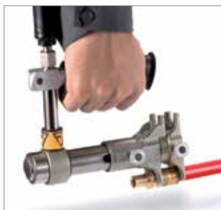
Rys. 16 6. Tuleję zaciskową dosunąć aż do pierścienia oporowego złączki. Połączenie typu tuleja zaciskowa jest odporne na ciśnienie i temperaturę bezpośrednio po montażu.
