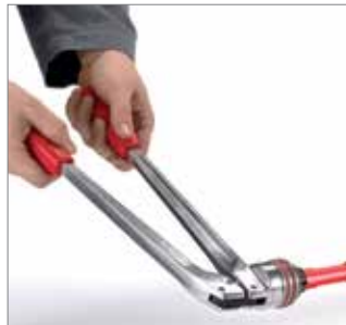
Rys. 13 3. Kielichować rurę dwukrotnie za pomocą głowicy kielichującej, obracając ją o ok. 30°. Możliwe jest również kielichowanie za pomocą ekspandera (nie przedstawione na rysunku)
