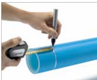
Rys. 66 Do zaznaczania obszaru zgrzewania użyć pisaka w kolorze innym niż rura.
