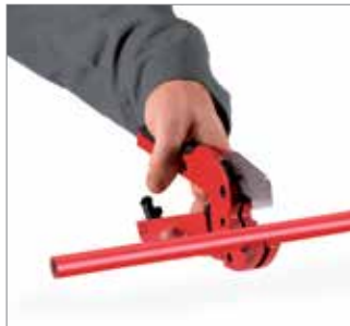
Rys. 11 1. Przyciąć rurę na żądaną długość pod kątem prostym i z zachowaniem gładkich krawędzi.
