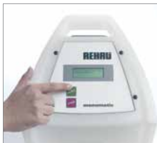
Rys. 101 Naciśnąć przycisk Start na zgrzewarce i sprawdzić wskazania jak poniżej. Porównać parametry zgrzewania widoczne na wyświetlaczu z informacją na złączce elektrooporowej FUSAPEX.
