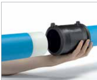
Rys. 47 8. Koniec drugiej rury wsunąć w mufę, tak aby odcinek rury bez powłoki był całkowicie wsunięty w mufę.
