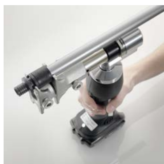
3 Zaciśnięcie tulei i złączki
