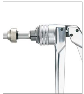
Rys. 14-6 Kielichowanie rury przyłączeniowej
