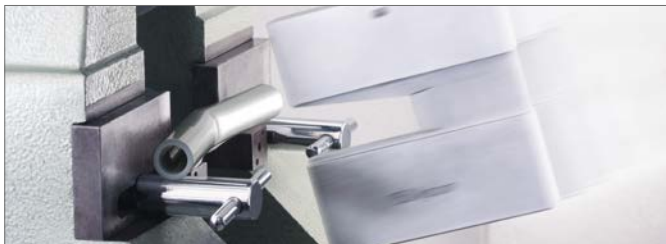
Rys. 3-2 Rura uniwersalna RAUTTAN flex w urządzeniu do badania udarności
