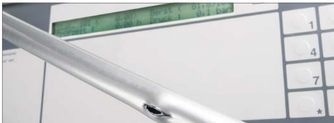
Rys. 3-1 Wynik badania ciśnienia rozrywającego z rurą uniwersalną RAUTTAN flex
