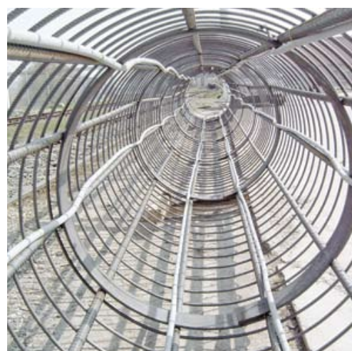
Kolumna geotermalna przed montażem
